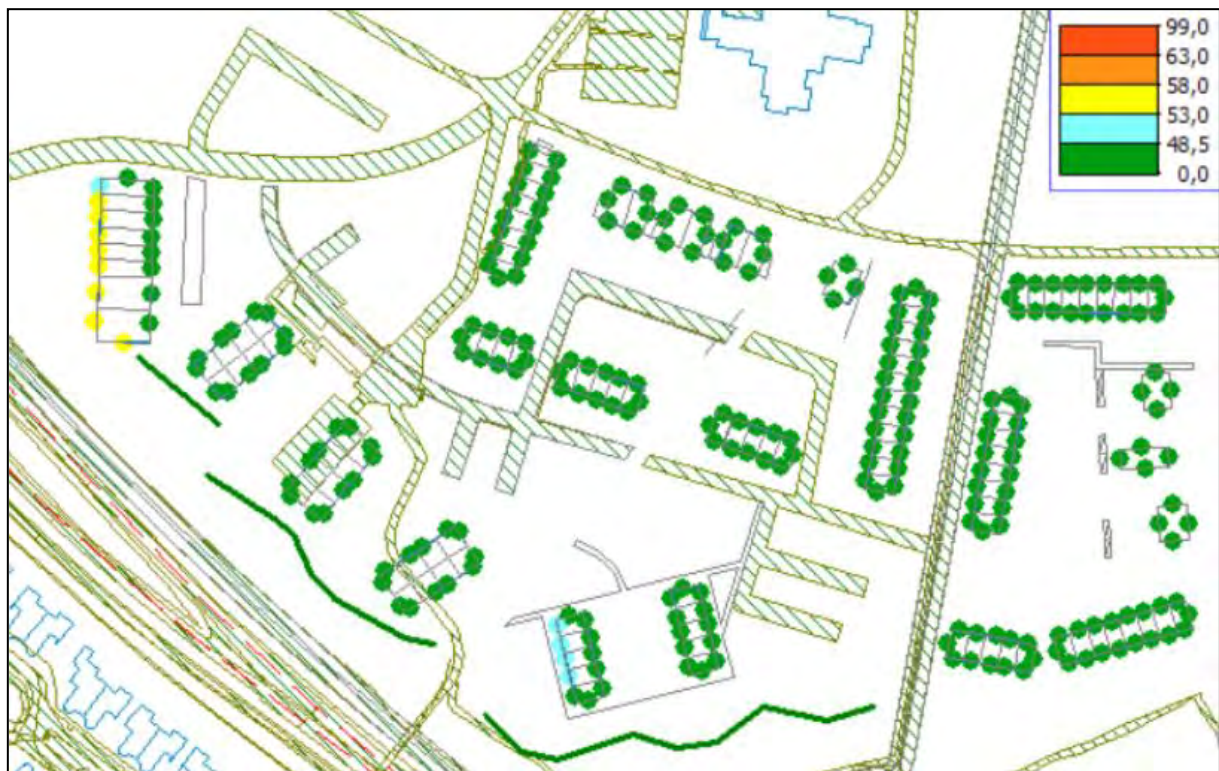
Figuur 4: Mogelijke ligging geluidswallen (8 meter hoog) en geluidsbelasting vanwege Dolderseweg (bron: akoestisch onderzoek)
