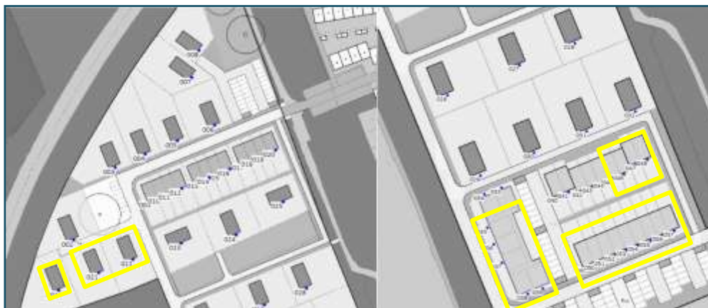
Figuur 5 Overschrijdingen (geel omkaderd) vanwege wegverkeer op de A28 voor 'model hofjes' noordelijke gedeelte (links) en zuidelijke gedeelte (rechts)
