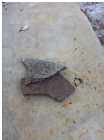
Foto 15: asbestverdacht materiaal proefgat 109
