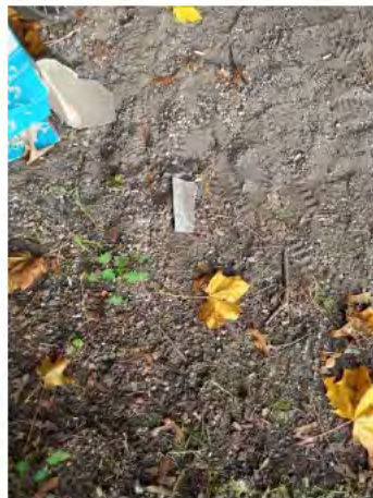
Foto 9: asbestverdacht materiaal nabij bergingen en fietsenstalling
