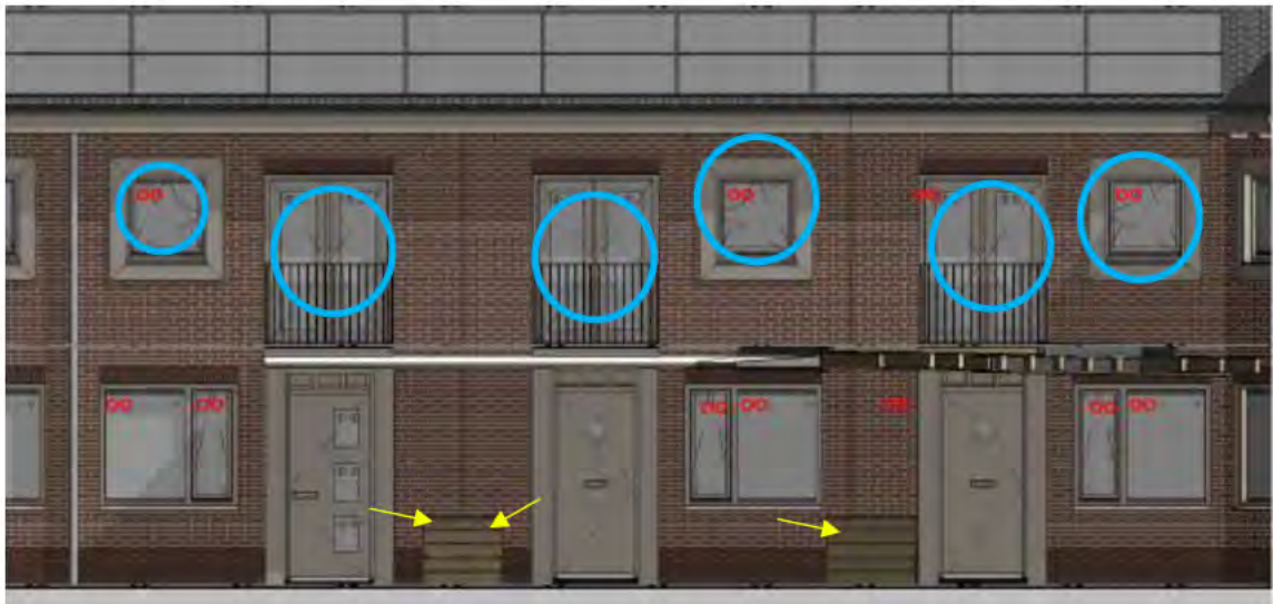
Figuur 5 Gevelaanzicht met warmtepompen
